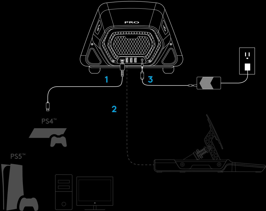
El conector de alimentación debe estar totalmente insertado para que el volante PRO funcione debidamente. Al insertar el conector, podrías notar un ligero clic. Puedes seguir haciendo presión hasta que el conector esté insertado del todo. No apliques demasiada fuerza para insertar el conector.
